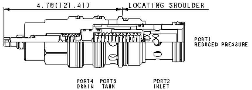
Dieses vorgesteuerte 3-Wege-Druckregelventil mit externer Entlastung reduziert einen hohen Primärdruck an Anschluss 2 auf einen niedrigeren, geregelten Druck an Anschluss 1. Bei Überdruck an Anschluss 1 fließt das Öl über Anschluss 3 zum Tank ab. Das Ventil wird nicht durch Staudruck an Anschluss 3 (Tank) beeinflusst, da die Vorsteuerung separat zu Anschluss 4 entlastet wird, der auch zur Fernsteuerung verwendet werden kann.
