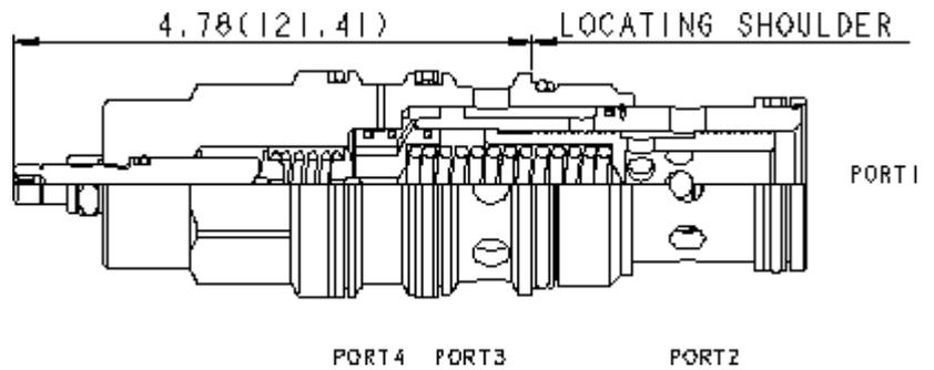
Entlastbare, vorgesteuerte 3-Wege-Druckregelventile reduzieren einen hohen Primärdruck an Anschluss 2 auf einen niedrigeren, geregelten Druck an Anschluss 1. Bei Überdruck an Anschluss 1 fließt Öl über Anschluss 3 zum Tank ab. Der Entlastungsanschluss 4 kann auch zur Fernsteuerung verwendet werden.
