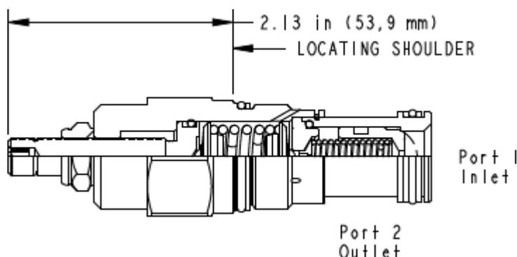
Direkt gesteuerte Vorsteuer-Druckbegrenzungsventile werden zur Fernsteuerung der Druckeinstellung anderer vorgesteuerter Ventile benutzt. Der Durchfluss dieser Ventile ist auf Steuerölmenge begrenzt und sie sollten deshalb nur zusammen mit Hauptstufenventilen eingesetzt werden.
