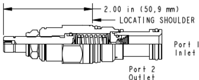
Les limiteurs de pression de pilotage à action directe sont utilisés pour contrôler à distance le tarage d'autres valves à action pilotée. Parce que leur capacité est limitée à un débit de pilotage ces valves devraient être utilisées avec des cartouches dont les débits sont supérieurs.
