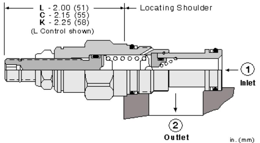
Direkt gesteuerte Vorsteuer-Druckbegrenzungsventile werden zur Fernsteuerung der Druckeinstellung anderer vorgesteuerter Ventile benutzt. Der Durchfluss dieser Ventile ist auf Steuerölmenge begrenzt und sie sollten deshalb nur zusammen mit Hauptstufenventilen eingesetzt werden.
