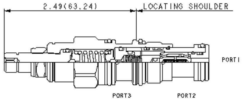
Dieses direktbetätigte Vorsteuerventil enthält ein Wechsel-Rückschlagventil. Dies ermöglicht die Vorsteuerung von zwei Ventilen oder es ist einsetzbar als thermische Druckbegrenzung beider Seiten eines Zylinders. Der Durchfluss ist auf Steuerölstrom begrenzt. Das Ventil eignet sich zur Vorsteuerung von Ventilen mit vergleichbarem Steuerölfluss.
