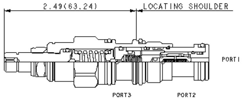
Ce limiteur de pression de pilotage à action directe intègre un sélecteur de circuit à double clapet qui lui permet de contrôler à distance 2 valves à action pilotée ou de servir de protection contre la dilatation thermique aux deux extrémités d'un récepteur. Cette cartouche est conçue pour des débits de pilotage et doit donc être utilisée avec 2 valves dont les débits de pilotages générés sont compatibles.
