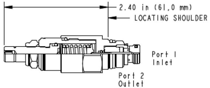
Les étages pilotes limiteurs de pression, à 2 voies à action directe sont des cartouches de limiteurs de pression réglables normalement fermés. Quand la pression de la chambre 1 (alimentation) est suffisante pour vaincre la force du ressort de tarage de la valve, un passage de débit s'établit de la chambre 1 à la chambre 2 (réservoir).
