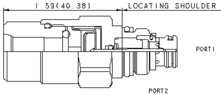
Dieses pneumatisch betätigte Vorsteuer-Druckbegrenzungsventil mit zwei Anschlüssen ist in Ruhestellung geschlossen und eignet sich nur für kleine Volumenströme. Bei Erreichen des Druckeinstellwertes an Anschluss 1, der pneumatisch vorgegeben wird, öffnet das Ventil von Anschluss 1 nach 2 (Tank). Das Ventil nutzt das T-8A Bohrkonzzept und eignet sich als Vorsteuerventil in Hauptstufenventilen von SUN.
