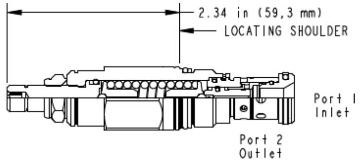
Das bidirektionale, direkt gesteuerte Druckbegrenzungsventil ist ein in Ruhestellung geschlossenes Druckbegrenzungsventil zum Schutz von Hydraulikkomponenten vor zu hohen Drücken. Wenn die Druckdifferenz zwischen den Anschlüssen 1 und 2 die Ventileinstellung überschreitet öffnet das Ventil und reduziert die Druckdifferenz richtungsunabhängig.
