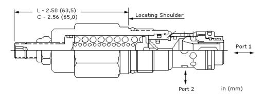
Les limiteurs de pression à action directe bidirectionnels sont des valves normalement fermées utilisées pour protéger les composants d'un circuit hydraulique des pics de pression. Lorsque la pression différentielle entre les orifices 1 et 2 dépasse la valeur de tarage, la valve s'ouvre, étranglant le débit pour limiter l'augmentation de pression, quel que soit le sens de passage de débit. Les tarages et performances sont similaires dans les 2 directions.
