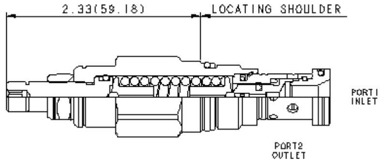
Direkt gesteuerte Druckbegrenzungsventile sind in der Ruhestellung geschlossene Regelemente und schützen hydraulische Bauteile vor Druckstößen. Wenn der Druck (Anschluss 1) den Einstellwert des Ventils überschreitet, wird der überschüssige Druck zum Tank (Anschluss 2) entlastet. Diese Ventile arbeiten stabil, leise, sind praktisch leckagefrei, unempfindlich gegen Ölverschmutzung sowie Klebeffekt und sind sehr reaktionsschnell.
