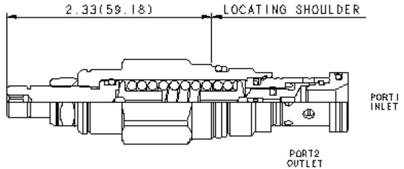
直动式溢流阀为常闭压力限制阀，常用来保护液压元件，以防止其受瞬态压力的冲击。当压力在进口（口1）达到阀的设定值，阀开始向油箱（口2）溢流，节流以限制压力上升。此类阀调节平稳、噪声小，基本为零泄漏，抗油污能力强，防堵塞并且响应速度快。
