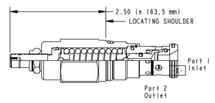
Direkt gesteuerte Druckbegrenzungsventile sind in der Ruhestellung geschlossene Regelelemente und schützen hydraulische Bauteile vor Druckstößen. Wenn der Druck
