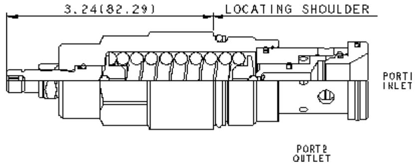
Direkt gesteuerte Druckbegrenzungsventile sind in der Ruhestellung geschlossene Regelemente und schützen hydraulische Bauteile vor Druckstößen. Wenn der Druck (Anschluss 1) den Einstellwert des Ventils überschreitet, wird der überschüssige Druck zum Tank (Anschluss 2) entlastet. Diese Ventile arbeiten stabil, leise, sind praktisch leckagefrei, unempfindlich gegen Ölverschmutzung sowie Klebeeffekt und sind sehr reaktionsschnell.
