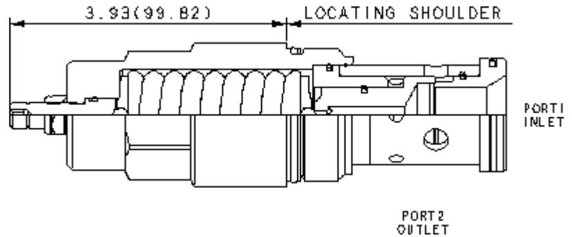
Direkt gesteuerte Druckbegrenzungsventile sind in der Ruhestellung geschlossene Regelelemente und schützen hydraulische Bauteile vor Druckstößen. Wenn der Druck (Anschluss 1) den Einstellwert des Ventils überschreitet,
