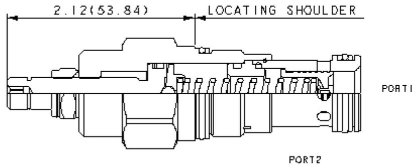
Direkt gesteuerte Druckbegrenzungsventile, in Ruhestellung geschlossen, schützen Hydraulikkomponenten vor einem zu hohen Druck. Der maximale Druck wird mit dem Ventil begrenzt. Wenn der Druck am Einlass (Anschluss 1) die Ventileinstellung erreicht, öffnet das Ventil zum Tank (Anschluss 2) um den Druckanstieg zu begrenzen.
