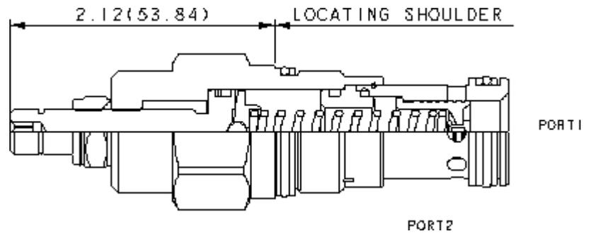
Les limiteurs de pression à action directe sont des valves de limitation de pression normalement fermées utilisées pour protéger les composants hydrauliques d'un circuit des pics de pression. Lorsque la pression à l'entrée (chambre 1) atteint la valeur de tarage, la valve s'ouvre vers le réservoir (chambre 2), étranglant le débit dérivé pour limiter l'augmentation de pression dans le circuit.
