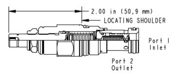
Les limiteurs de pression pilotés à piston équilibré sont des valves de régulation de pression normalement fermées. Lorsque la pression à l'entrée (chambre 1) atteint la valeur de tarage, la valve s'ouvre vers le réservoir (chambre 2), étranglant le débit pour réguler la pression. Ces valves sont précises avec une faible augmentation de la pression en fonction du débit. Elles sont silencieuses, sans à-coups avec un temps de réponse relativement rapide.
