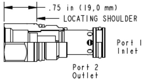
Cet élément de régulation normalement fermé à piston équilibré intègre une cavité de pilotage qui accepte toute valve de pression de pilotage utilisant la cavité T-8A. Lorsque la pression à l'entrée (chambre 1) atteint la valeur de tarage de la valve de pilotage, l'élément de régulation s'ouvre vers le réservoir (chambre 2), étranglant le débit pour réguler la pression. La pression de tarage de la valve de pilotage détermine la différence de pression entre la chambre 1 et la chambre 2.
