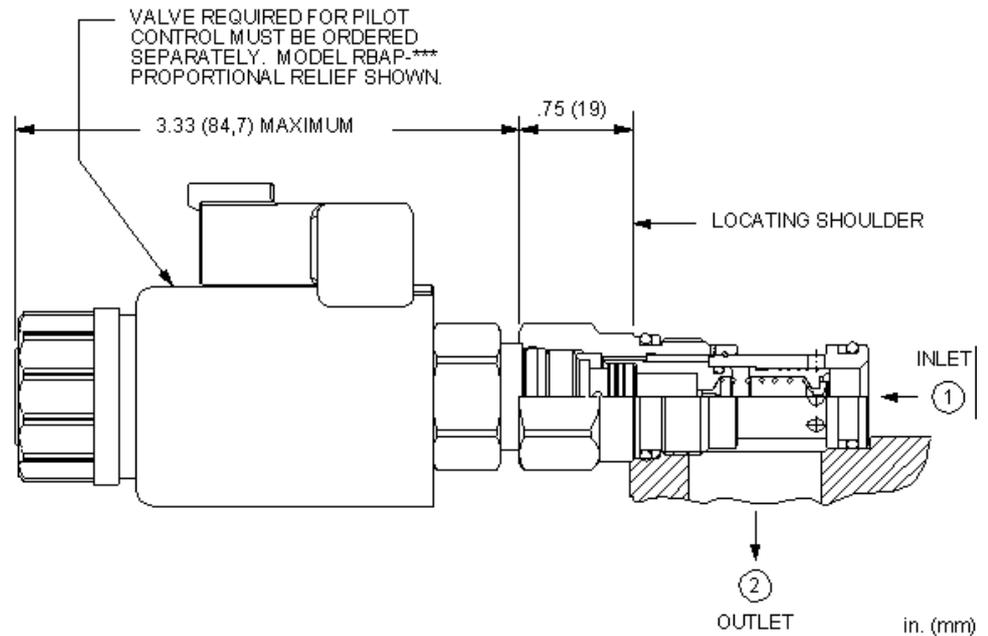
Dieses Druckregellement ist in der Ruhestellung geschlossen und mit einer Einschraubbohrung für ein Vorsteuerventil ausgestattet. Der Kolben ist druckausgeglichen. In die Einschraubbohrung kann jedes in die T-8A passende Druckventil eingesetzt werden. Wenn der Druck (Anschluss 1) den Einstellwert des Vorsteuerventils überschreitet, wird der überschüssige Druck zum Tank (Anschluss 2) entlastet. Die Einstellung des Vorsteuerventils bestimmt den Differenzdruck zwischen Anschluss 1 und 2.
