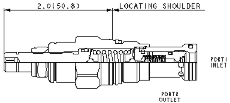
Les limiteurs de pression pilotés à clapet équilibré sont des valves de régulation de pression normalement fermées. Lorsque la pression à l'entrée (chambre 1) atteint la valeur de tarage, la valve s'ouvre vers le réservoir (chambre 2), étranglant le débit pour réguler la pression. Ces valves sont précises avec une faible augmentation de la pression en fonction du débit. Elles sont silencieuses, sans à-coups avec un temps de réponse rapide.
