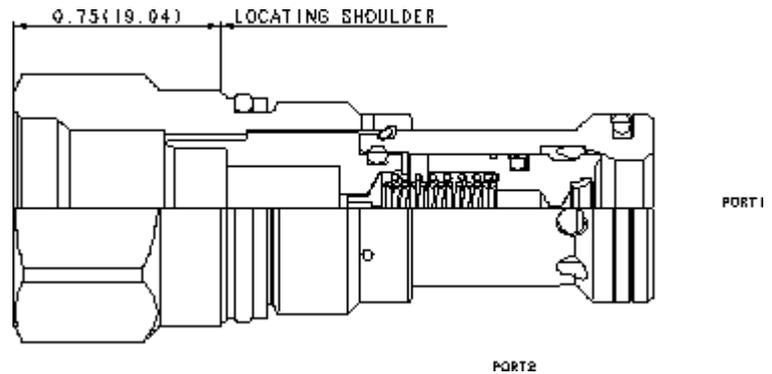
Cet élément de régulation normalement fermé à clapet équilibré intègre une cavité de pilotage qui accepte toute valve de pression de pilotage utilisant la cavité T-8A. Lorsque la pression à l'entrée (chambre 1) atteint la valeur de tarage de la valve de pilotage, l'élément de régulation s'ouvre vers le réservoir (chambre 2), étranglant le débit pour réguler la pression. La pression de tarage de la valve de pilotage détermine la différence de pression entre la chambre 1 et la chambre 2.
