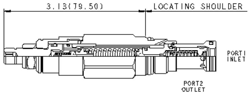
Les cartouches limiteurs de pression pilotés antichoc limitent la pression maxi du système, et limitent aussi la vitesse de montée en pression. La valve s'ouvre, puis elle se referme à une vitesse constante indépendante de la pression de tarage et du débit. La vis de réglage détermine la pression de tarage maximum (seuil haut) mais aussi la pression minimum (seuil bas).
