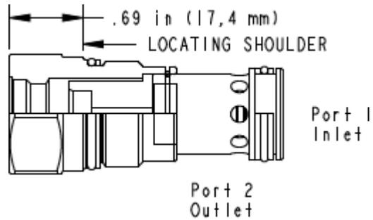
Cet élément de régulation normalement fermé à piston équilibré intègre une cavité de pilotage qui accepte toute valve de pression de pilotage utilisant la cavité T-8A. Lorsque la pression à l'entrée (chambre 1) atteint la valeur de tarage de la valve de pilotage, l'élément de régulation s'ouvre vers le réservoir (chambre 2), étranglant le débit pour réguler la pression. La pression de tarage de la valve de pilotage détermine la différence de pression entre la chambre 1 et la chambre 2.
