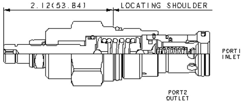
Les limiteurs de pression pilotés à clapet équilibré sont des valves de régulation de pression normalement fermées. Lorsque la pression à l'entrée (chambre 1) atteint la valeur de tarage, la valve s'ouvre vers le réservoir (chambre 2), étranglant le débit pour réguler la pression. Ces valves sont précises avec une faible augmentation de la pression en fonction du débit. Elles sont silencieuses, sans à-coups avec un temps de réponse rapide.
