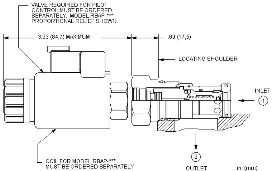
Cet élément de régulation normalement fermé à clapet équilibré intègre une cavité de pilotage qui accepte toute valve de pression de pilotage utilisant la cavité T-8A. Lorsque la pression à l'entrée (chambre 1) atteint la valeur de tarage de la valve de pilotage, l'élément de régulation s'ouvre vers le réservoir (chambre 2), étranglant le débit pour réguler la pression. La pression de tarage de la valve de pilotage détermine la différence de pression entre la chambre 1 et la chambre 2.
