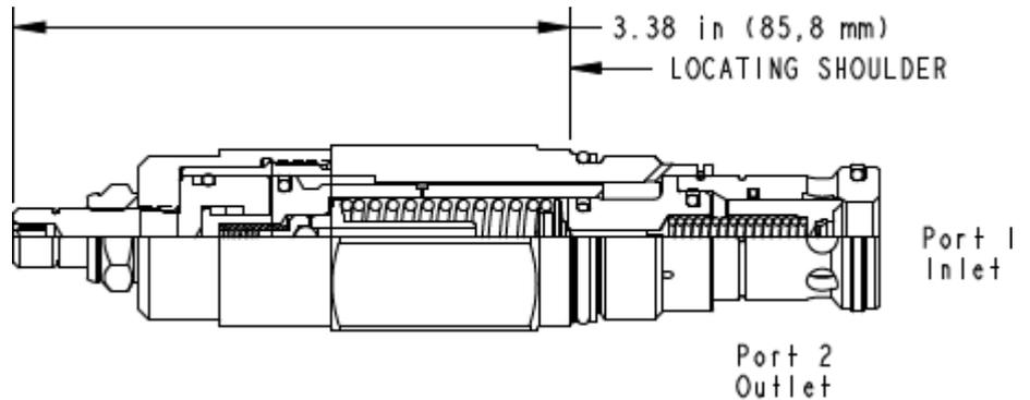
Vorgesteuerte, weiche Druckbegrenzungsventile begrenzen den maximalen Systemdruck und die Geschwindigkeit des Druckanstiegs. Das Ventil öffnet zuerst und schließt dann gleichmäßig rampenförmig vom unteren Druckeinstellwert (Schwellwert) auf den Maximalwert. Die Rampenzeit ist dabei unabhängig von der Ventileinstellung und dem Volumenstrom. Über die Verstellerschraube können der Maximalwert und der Schwellwert eingestellt werden.
