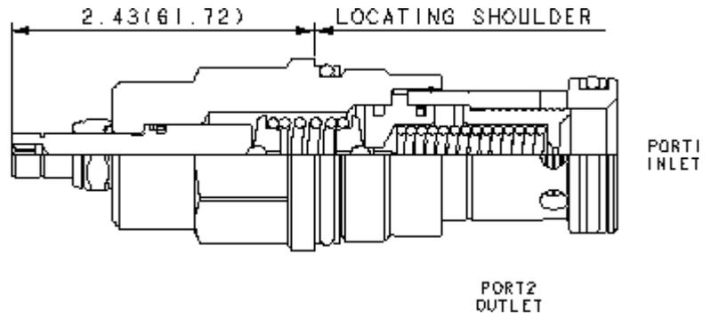
Vorgesteuerte Druckbegrenzungsventile sind in Ruhestellung geschlossene Steuerelemente mit druckausgeglichenem Hauptkolben. Wenn der Druck (Anschluss 1) den Einstellwert des Ventils überschreitet, wird der überschüssige Druck zum Tank (Anschluss 2) entlastet. Die Ventile sind genau, Druckanstieg über Volumenstrom ist gering, sie arbeiten stabil und ruhig und sind moderat schnell.
