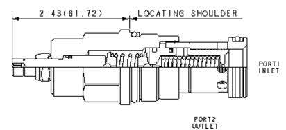
Les limiteurs de pression pilotés à piston équilibré sont des valves de régulation de pression normalement fermées. Lorsque la pression à l'entrée (chambre 1) atteint la valeur de tarage, la valve s'ouvre vers le réservoir (chambre 2), étranglant le débit pour réguler la pression. Ces valves sont précises avec une faible augmentation de la pression en
