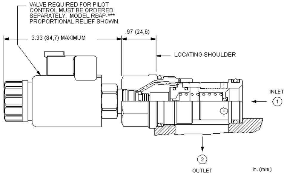
Dieses Druckregelgerät ist in der Ruhestellung geschlossen und mit einer Einschraubbohrung für ein Vorsteuerventil ausgestattet. Der Kolben ist druckausgeglichen. In die Einschraubbohrung kann jedes in die T-8A passende Druckventil eingesetzt werden. Wenn der Druck (Anschluss 1) den Einstellwert des Vorsteuerventils überschreitet, wird der überschüssige Druck zum Tank (Anschluss 2) entlastet. Die Einstellung des Vorsteuerventils bestimmt den Differenzdruck zwischen Anschluss 1 und 2.
