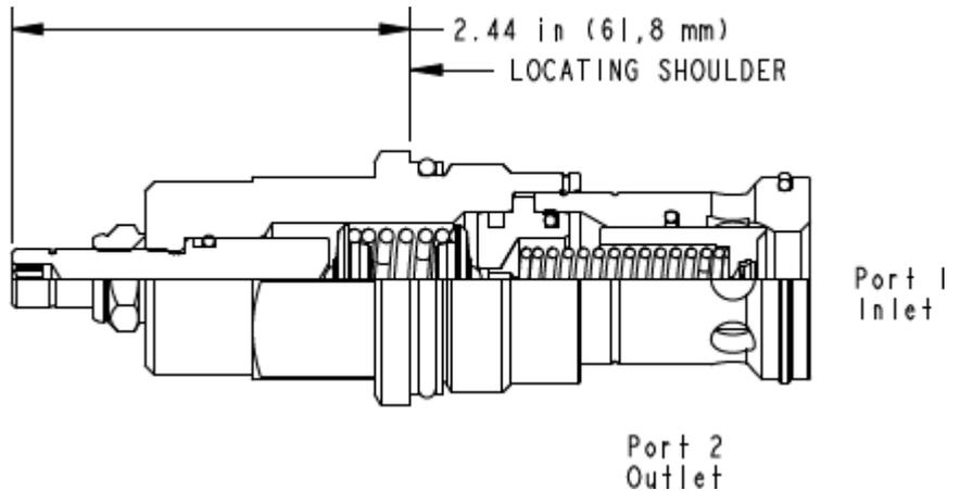
Les limiteurs de pression pilotés à clapet équilibré sont des valves de régulation de pression normalement fermées. Lorsque la pression à l'entrée (chambre 1) atteint la valeur de tarage, la valve s'ouvre vers le réservoir (chambre 2), étranglant le débit pour réguler la pression. Ces valves sont précises avec une faible augmentation de la pression en fonction du débit. Elles sont silencieuses, sans à-coups avec un temps de réponse rapide.
