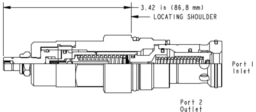
Vorgesteuerte, weiche Druckbegrenzungsventile begrenzen den maximalen Systemdruck und die Geschwindigkeit des Druckanstiegs. Das Ventil öffnet zuerst und schließt dann gleichmäßig rampenförmig vom unteren Druckeinstellwert (Schwellwert) auf den Maximalwert. Die Rampenzeit ist dabei unabhängig von der Ventileinstellung und dem Volumenstrom. Über die Verstellerschraube können der Maximalwert und der Schwellwert eingestellt werden.
