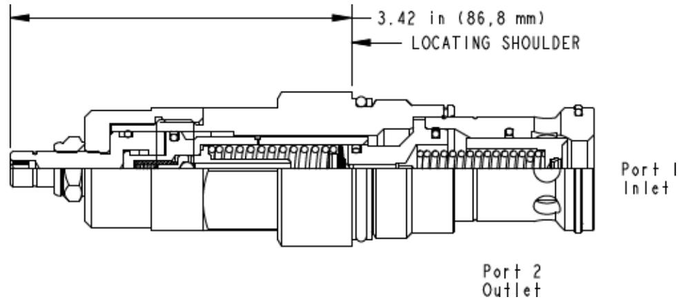
Vorgesteuerte, weiche Druckbegrenzungsventile begrenzen den maximalen Systemdruck und die Geschwindigkeit des Druckanstiegs. Das Ventil öffnet zuerst und schließt dann gleichmäßig rampenförmig vom unteren Druckeinstellwert (Schwellwert) auf den Maximalwert. Die Rampenzeit ist dabei unabhängig von der Ventileinstellung und dem Volumenstrom. Über die Verstellerschraube können der Maximalwert und der Schwellwert eingestellt werden.
