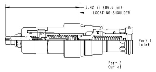
Les cartouches limiteurs de pression pilotés antichoc limitent la pression maxi du système, et limitent aussi la vitesse de montée en pression. La valve s'ouvre, puis elle se referme à une vitesse constante indépendante de la pression de tarage et du débit. La vis de réglage détermine la pression de tarage maximum (seuil haut) mais aussi la pression minimum (seuil bas).
