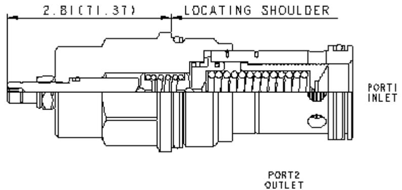
Vorgesteuerte Druckbegrenzungsventile sind in Ruhestellung geschlossene Steuerelemente mit druckausgeglichenem Hauptkolben. Wenn der Druck (Anschluss 1) den Einstellwert des Ventils überschreitet, wird der überschüssige Druck zum Tank (Anschluss 2) entlastet. Die Ventile sind genau, Druckanstieg über Volumenstrom ist gering, sie arbeiten stabil und ruhig und sind moderat schnell.
