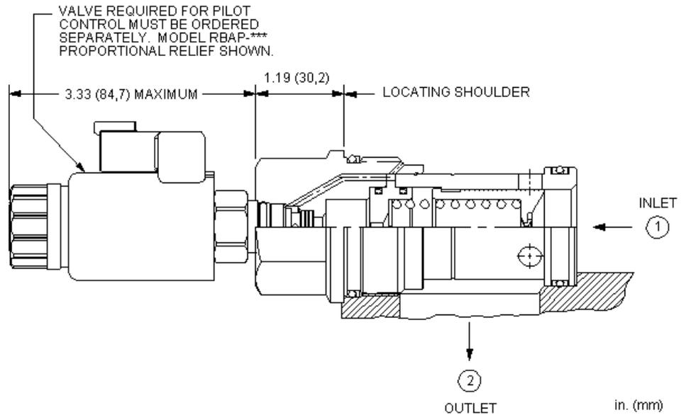
Dieses Druckregelement ist in der Ruhestellung geschlossen und mit einer Einschraubbohrung für ein Vorsteuerventil ausgestattet. Der Kolben ist druckausgeglichen. In die Einschraubbohrung kann jedes in die T-8A passende Druckventil eingesetzt werden. Wenn der Druck (Anschluss 1) den Einstellwert des Vorsteuerventils überschreitet, wird der überschüssige Druck zum Tank (Anschluss 2) entlastet. Die Einstellung des Vorsteuerventils bestimmt den Differenzdruck zwischen Anschluss 1 und 2.
