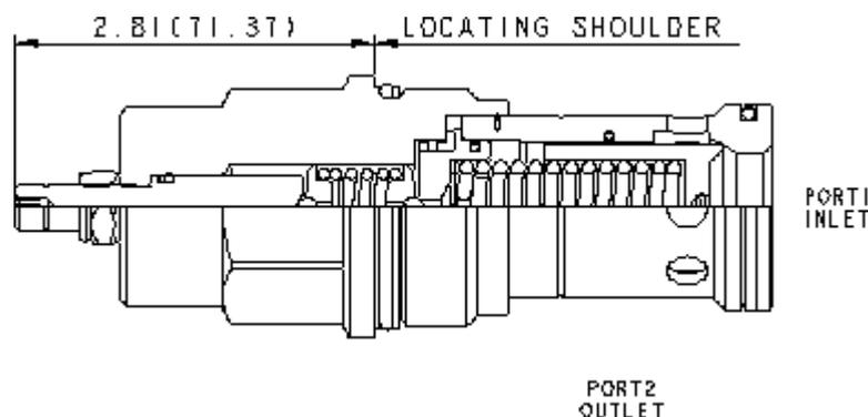
Vorgesteuerte Druckbegrenzungsventile sind in Ruhestellung geschlossene Regelemente mit druckausgeglichenem Hauptkolben in Sitzbauweise. Wenn der Druck (Anschluss 1) den Einstellwert des Ventils überschreitet, wird der überschüssige Druck zum Tank (Anschluss 2) entlastet. Die Ventile sind genau, Druckanstieg über Volumenstrom ist gering, sie arbeiten stabil und ruhig und sind moderat schnell.
