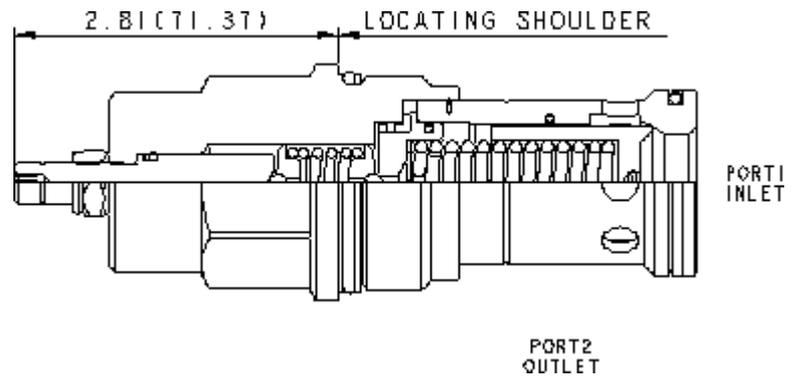
Vorgesteuerte Druckbegrenzungsventile sind in Ruhestellung geschlossene Regelelemente mit druckausgeglichenem Hauptkolben in Sitzbauweise. Wenn der Druck (Anschluss 1) den Einstellwert des Ventils überschreitet, wird der überschüssige Druck zum Tank (Anschluss 2) entlastet. Die Ventile sind genau, Druckanstieg über Volumenstrom ist gering, sie arbeiten stabil und ruhig und sind moderat schnell.
