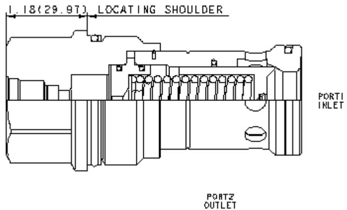
Cet élément de régulation normalement fermé à clapet équilibré intègre une cavité de pilotage qui accepte toute valve de pression de pilotage utilisant la cavité T-8A. Lorsque la pression à l'entrée (chambre 1) atteint la valeur de tarage de la valve de pilotage, l'élément de régulation s'ouvre vers le réservoir (chambre 2), étranglant le débit pour réguler la pression. La pression de tarage de la valve de pilotage détermine la différence de pression entre la chambre 1 et la chambre 2.
