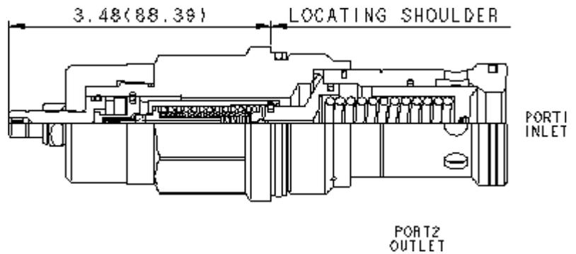
Les cartouches limiteurs de pression pilotés antichoc limitent la pression maxi du système, et limitent aussi la vitesse de montée en pression. La valve s'ouvre, puis elle se referme à une vitesse constante indépendante de la pression de tarage et du débit. La vis de réglage détermine la pression de tarage maximum (seuil haut) mais aussi la pression minimum (seuil bas).
