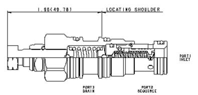
Vorgesteuerte Druckfolgeventile mit druckausgeglichenem Kolben erlauben den Durchfluss in einen zweiten Kreis, sobald der Druck an Anschluss 1 den Einstellwert des Ventils übersteigt. Die Druckeinstellung eines Druckfolgeventils regelt den Druck an Anschluss 1 abhängig vom Druck an Anschluss 3. Diese Ventile sind unterhalb ihres Einstellwertes vom Druck an Anschluss 2 unabhängig. Bei Staudruck in Rückleitungen zum Tank
