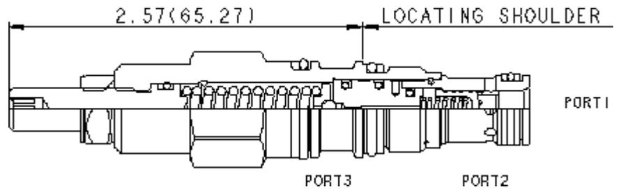
Diese 3-Wege-Druckwaage ist ein in der Ruhestellung geschlossenes Regelement mit Druckbegrenzungsfunktion, das zusammen mit einer externen Blende zwei Funktionen erfüllt: Der Hauptkolben der 3-Wege-Druckwaage hält die Druckdifferenz über die externe Blende konstant. Überschüssiger Volumenstrom wird zum Tank (Anschluss 2) abgeführt. Bei Erreichen des Druckeinstellwerts verhält sich das Ventil wie ein Druckbegrenzungsventil.
