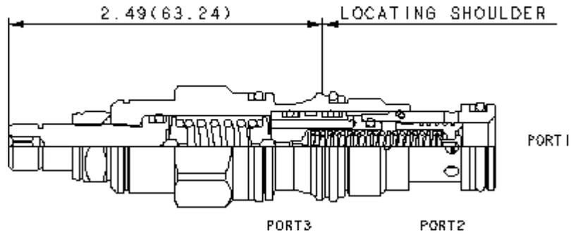
Diese 3-Wege-Druckwaage ist ein in der Ruhestellung geschlossenes Regelement mit Druckbegrenzungsfunktion, das zusammen mit einer externen Blende zwei Funktionen erfüllt: Der Hauptkolben der 3-Wege-Druckwaage hält die Druckdifferenz über die externe Blende konstant. Überschüssiger Volumenstrom wird zum Tank (Anschluss 2) abgeführt. Bei Erreichen des Druckeinstellwerts verhält sich das Ventil wie ein Druckbegrenzungsventil.
