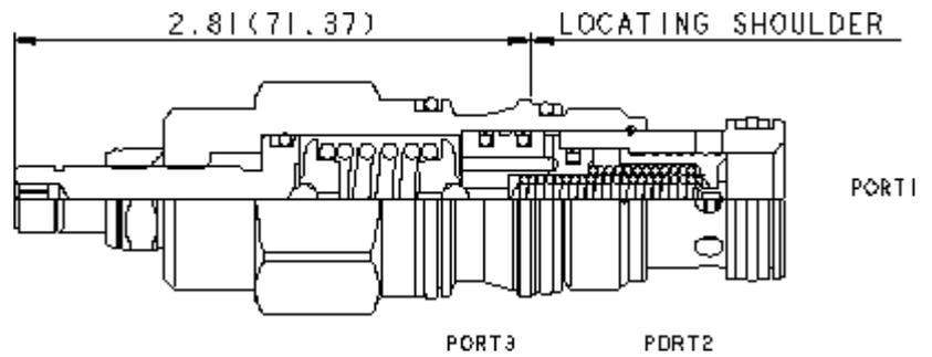
Diese 3-Wege-Druckwaage ist ein in der Ruhestellung geschlossenes Regelement mit Druckbegrenzungsfunktion, das zusammen mit einer externen Blende zwei Funktionen erfüllt: Der Hauptkolben der 3-Wege-Druckwaage hält die Druckdifferenz über die externe Blende konstant. Überschüssiger Volumenstrom wird zum Tank (Anschluss 2) abgeführt. Bei Erreichen des Druckeinstellwerts verhält sich das Ventil wie ein Druckbegrenzungsventil.
