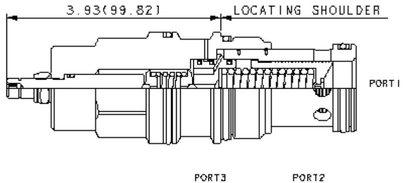
Diese 3-Wege-Druckwaage ist ein in der Ruhestellung geschlossenes Regelement mit Druckbegrenzungsfunktion, das zusammen mit einer externen Blende zwei Funktionen erfüllt: Der Hauptkolben der 3-Wege-Druckwaage hält die Druckdifferenz über die externe Blende konstant. Überschüssiger Volumenstrom wird zum Tank (Anschluss 2) abgeführt. Bei Erreichen des Druckeinstellwerts verhält sich das Ventil wie ein Druckbegrenzungsventil.
