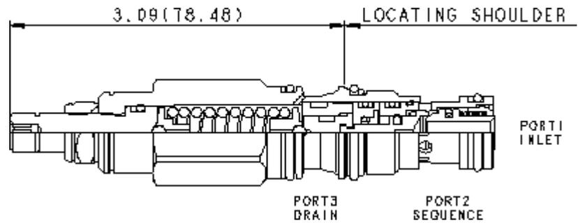
Ein direktbetätigtes Druckfolgeventil mit Rückschlagventil erlaubt den Durchfluss in einen zweiten Kreis, sobald der Druck an Anschluss 1 den Einstellwert des Ventils übersteigt. Zusätzlich verfügt dieses Ventil über ein Rückschlagventil, das den Durchfluss von Anschluss 2 (Folge) nach Anschluss 1 (Zulauf) ermöglicht. Die Druckeinstellung eines Druckfolgeventils regelt den Druck an Anschluss 1 abhängig vom Druck am Leckölanschluss 3.
