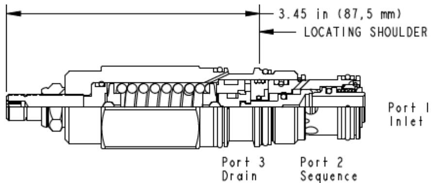
Les valves de séquence à action directe avec drainage externe et clapet anti-retour alimentent un circuit secondaire en huile dès que la pression à l'entrée (orifice 1) est supérieure au tarage de la valve. De plus, ces valves intègrent un clapet anti-retour qui permet un passage libre de l'orifice 2 (séquence) vers l'orifice 1 (entrée). La pression de tarage de la valve de séquence commande la pression à l'orifice 1 en fonction de la pression au drain (orifice 3).
