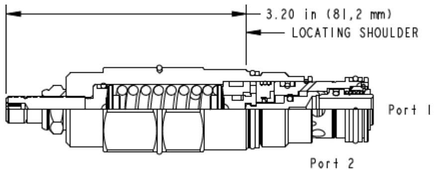
Les valves de séquence à action directe avec évent atmosphérique et clapet anti-retour alimentent un circuit secondaire en huile dès que la pression à l'entrée (orifice 1) est supérieure au tarage de la valve. De plus, ces valves intègrent un clapet anti-retour qui permet un passage libre de l'orifice 2 (séquence) vers l'orifice 1 (entrée). La pression de tarage de la valve de séquence commande la pression à l'orifice 1 en fonction de la pression à l'évent atmosphérique.
