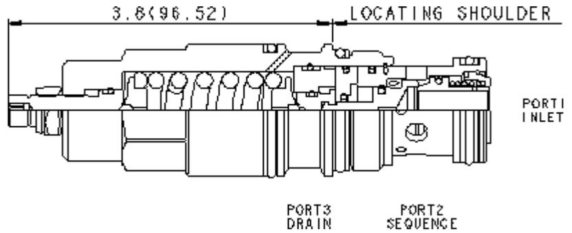
Ein direktbetätigtes Druckfolgeventil mit Rückschlagventil erlaubt den Durchfluss in einen zweiten Kreis, sobald der Druck an Anschluss 1 den Einstellwert des Ventils übersteigt. Zusätzlich verfügt dieses Ventil über ein Rückschlagventil, das den Durchfluss von Anschluss 2 (Folge) nach Anschluss 1 (Zulauf) ermöglicht. Die Druckeinstellung eines Druckfolgeventils regelt den Druck an Anschluss 1 abhängig vom Druck am Leckölanschluss 3.
